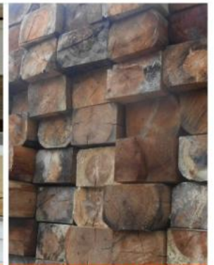
ТРЕЩИНА С ВЫХОДОМ НА ВЕРХнюю ПЛАСТЬ И ГНИЛЬ
